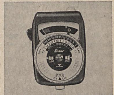
Der universelle Belichtungsmesser mit CdS-Fotowiderstand für alle Lichtverhältnisse. Genaues stufenloses Einstellen durch den Nachführzeiger. Zeiger-Arretierung. Bequemes Ablesen in zwei Meßbereichen. Für Licht- und Objektivmessung.
