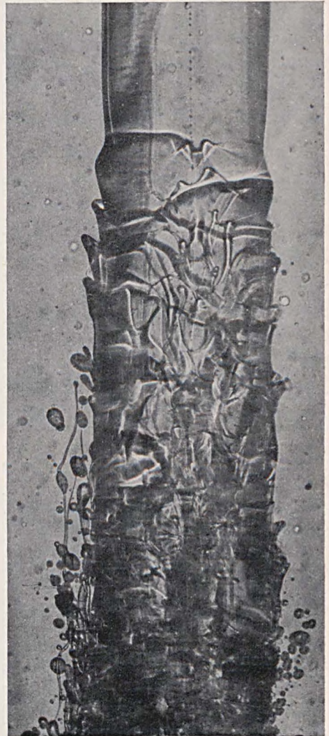
Bild 2: Strahlenzerstäubung bei Injektion von Flüssigkeit
