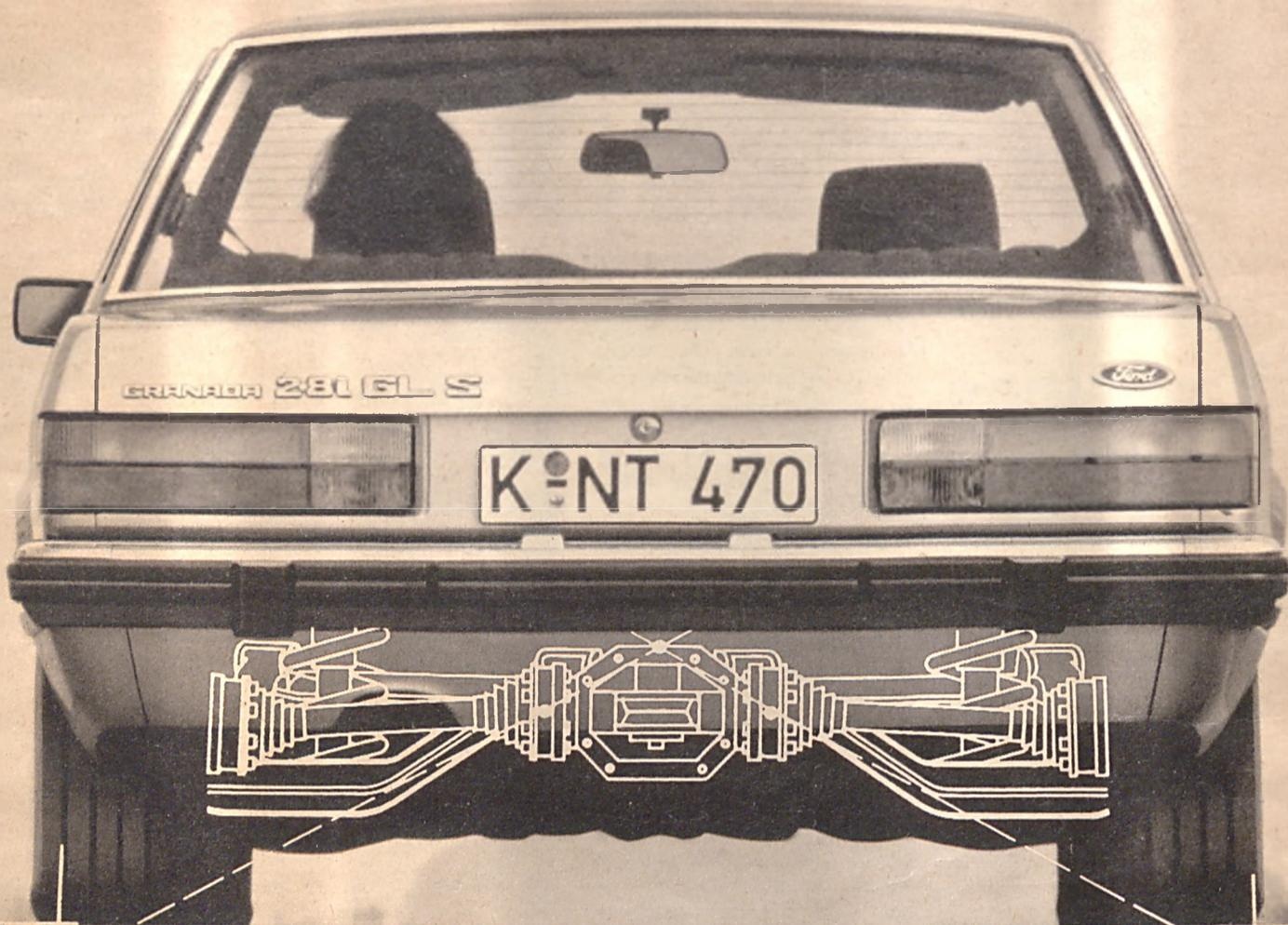
Tiefergelegte Karosserie. Auf „sportlich“ abgestimmte Gasdruck-Stoßdämpfer. Progressiv ansprechende Schraubenfedern hinten. Querstabilisator vorn mit höherer Kennung. Der Granada versetzt Sie in eine beneidenswerte Lage: Schlechte Straßen schlagen auch dank seiner Doppelgelenk-Schräglenker-Hinterachse kaum zu Ihnen durch. Das Ergebnis auf schneller wie auf kurviger Strecke: das schöne Gefühl, sicher zu fahren.
