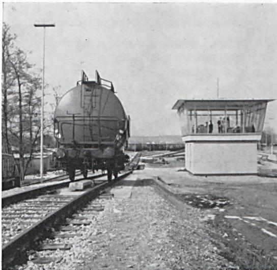
Abbildung: Gleisfahrzeugwaage im Ablaufberg mit vollautomatischem Leuchtbild- Wäge- und Druckautomat.
